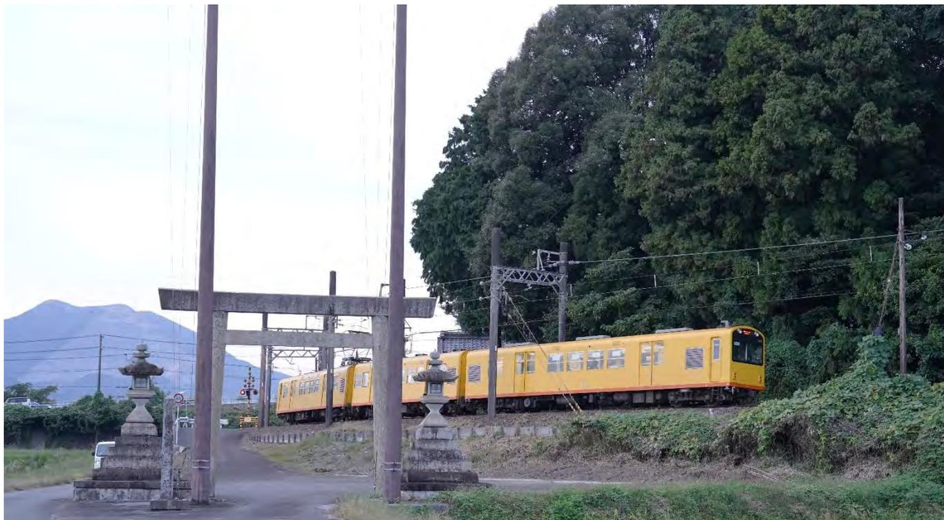
写真 北勢線における最小曲線半径 (R = 80m) が存する楚原～麻生田間・八幡神社踏切
