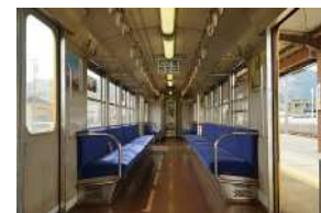
写真 車両幅の小ささを要因とする車内の狭さ
