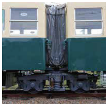
車両と車両を台車で連結する200系の連接台車
